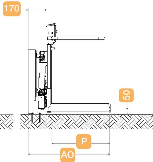
Plataforma plegada con fijación a pared
